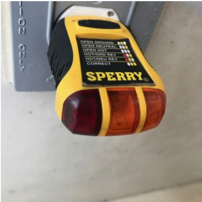
NON FUNCTIONAL EXTERIOR OUTLETS
